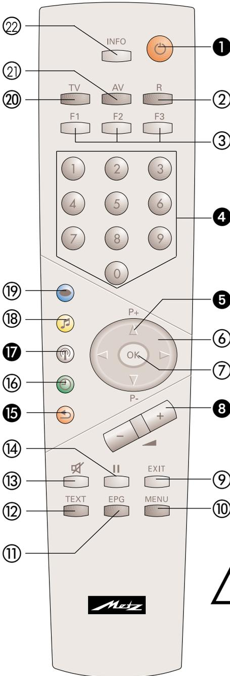
Die Fernbedienung übermittelt die Steuerbefehle per Infrarotlicht zum TV-Gerät. Die Fernbedienung muss immer zum TV-Gerät gerichtet sein. Andere infrarotgesteuerte Geräte oder Systeme (z.B. Infrarot-Kopfhörer) im Wirkungsbereich können u.U. gestört werden.
