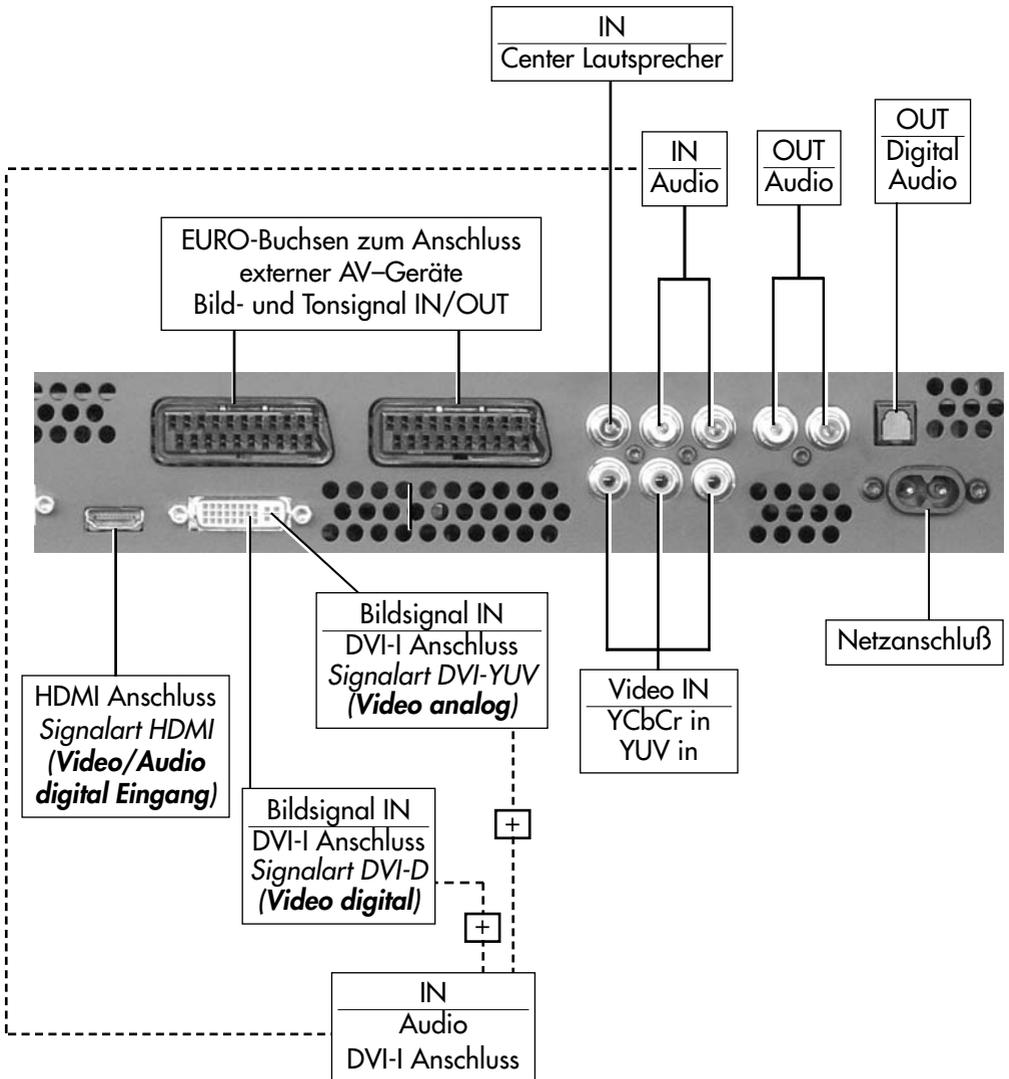
☞ **Mit einem optischen Audiokabel („Toslink“ im Zubehörhandel erhältlich), kann das zur Verfügung gestellte Digitale Audio Signal zur externen Verarbeitung weitergeleitet werden.**
