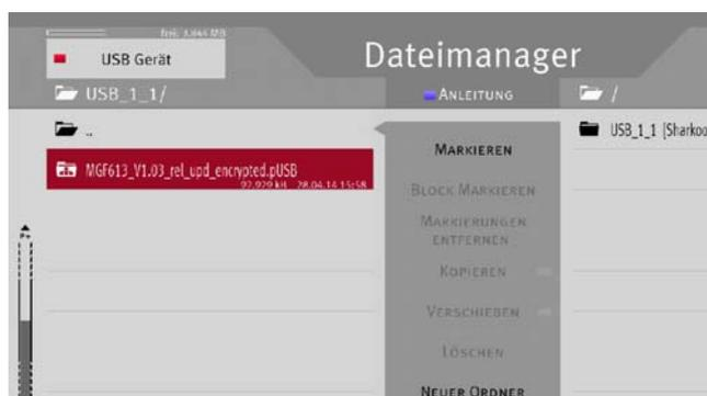
Wählen Sie Ihr USB-Gerät aus, auf dem sich das FW-Update befindet, gehen mit der Cursortaste auf die die Firmware-Datei (z.B. **MGF613\_V\*\*\*\*.pUSB**) und drücken zum Ausführen die Taste **OK**.
