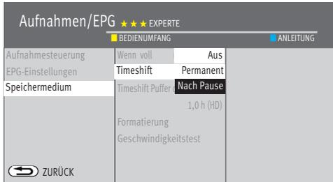
Das TV-Gerät kann im digitalen Zwischenspeicher (Timeshiftpuffer) Aufzeichnungen speichern. Dieser Zwischenspeicher ist ausreichend für eine Aufzeichnungsdauer von ca. 130-480 min (SD) und 70-240 min (HD=HDTV-Sendungen). Diese Angaben sind nur ca. Werte, die in Abhängigkeit von der Datenmenge der Aufzeichnung variieren können. Bei Verwendung eines internen oder externen Massenspeichers (Festplatte) ist die Aufzeichnungsdauer wesentlich länger.
